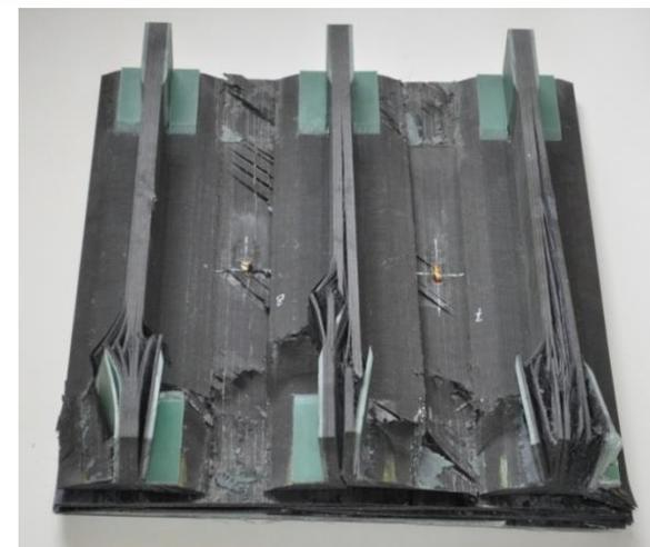
среднее экспериментальное напряжение разрушения- 59 кгс/мм<sup>2</sup>
