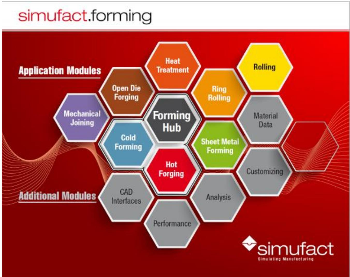
В своем составе **Simufact.forming** имеет ядро (Forming Hub) включающее базовый функционал, необходимый для моделирования основных технологических процессов (графический интерфейс пользователя, решатель, база материалов, средства построения конечно-элементной сетки и некоторые другие). Традиционно это ядро поставляется с элементами интерфейса, ориентированными на подготовку расчетных моделей процессов холодной и горячей штамповки.
